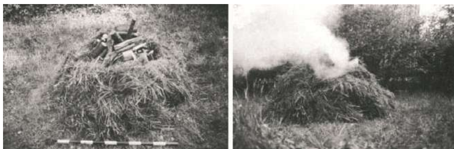
Ein Nachbau eines Meilerofens vor dem Anfeuern (links) und während des Keramikbrandes(rechts)
